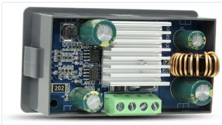
Čtyřpólová vyvýšená šroubovací svorkovnice na plošném spoji, zesílený chladič a prstencová tlumivka. The four-pole lift-type screw terminal block on the PCB, the thickened heatsink and the ring inductor.
